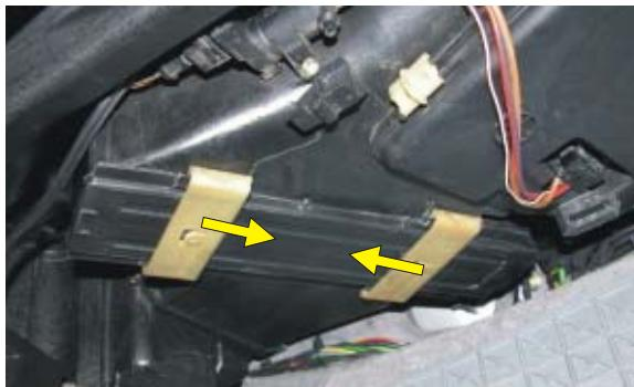
**PL** Przesunąć blokady zabezpieczające pokrywy komory filtra
